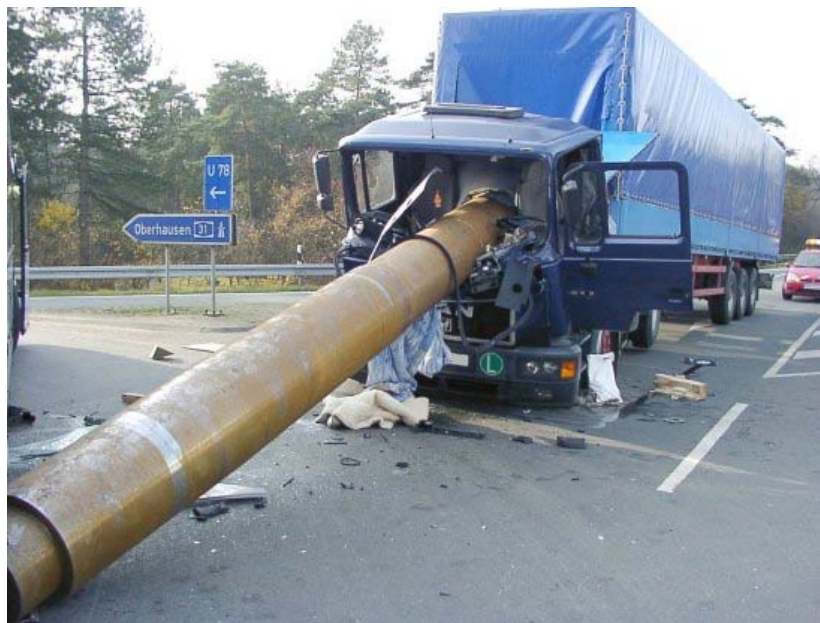
Rys. 1: Podczas gwałtownego hamowania źle zamocowane stalowe rury przebiły ścianę przednią naczepy i kabinę kierowcy.
