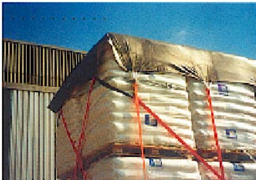
Rys. 42. Ośłona z odciągami
