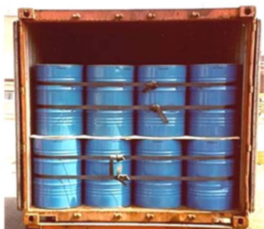
Rys. 89. Beczki luzem w dwóch warstwach i czterech rzędach w kontenerze
