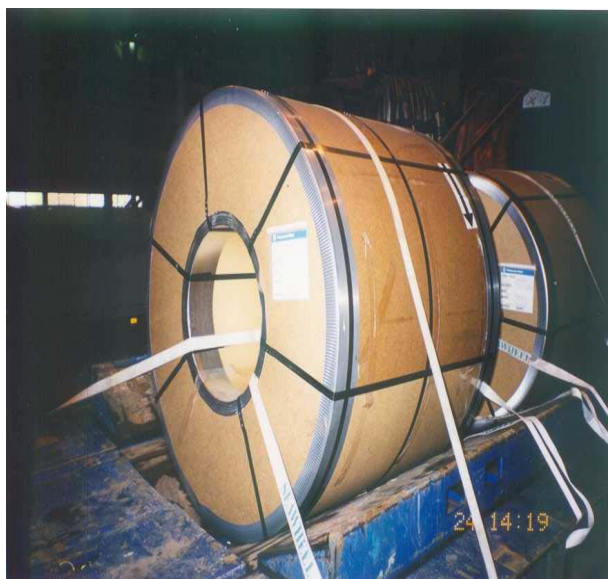
Taśmy przeprowadzone przez zwój i nad nim
