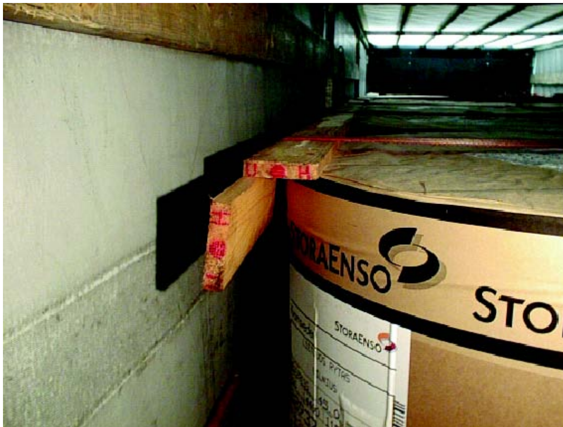
53. Listwa kątowna wykonana z desek drewnianych
